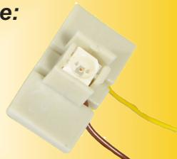
**Platine mit einer LED für Hausbeleuchtung:**
