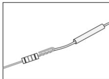
8. Schieben Sie den Schrumpfschlauch auf die zuvor hergestellte Kontaktstelle (Kabel + Widerstand).
