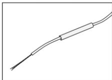
5. Schieben Sie das gelbe Stück Schrumpfschlauch auf das gelbe Kabel. Isolieren Sie das Kabel ca. 8 – 10 mm ab.
