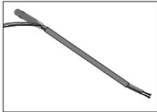
2. Es folgt der Lampenmast, auch er wird auf die beiden Kabel aufgeschoben.
