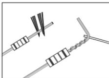
6. Biegen Sie den kurzen Draht des Widerstandes in der Mitte um 90 Grad. Wickeln Sie das blanke Kabelende des gelben Kabels um das Drahtstück direkt unterhalb des Widerstandes.
