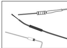
10. In gleicher Weise verfährt man mit dem braunen Kabel, dem schwarzen Schrumpfschlauch und der Diode.
