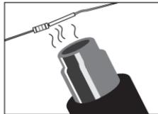
9. Kurz (!) erhitzen, etwa mit einem Heißluftpistole oder einem Feuerzeug. Schon ist die dauerhafte Verbindung fertig! Vorsicht Verbrennungsgefahr!
