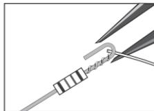
7. Anschließend biegen Sie das senkrecht hochstehende Ende des Widerstandes um.
