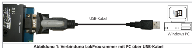
Abbildung 1: Verbindung LokProgrammer mit PC über USB-Kabel
