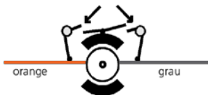
Abbildung 9: 5-poliger Märklin® Hochleistungsmotor
