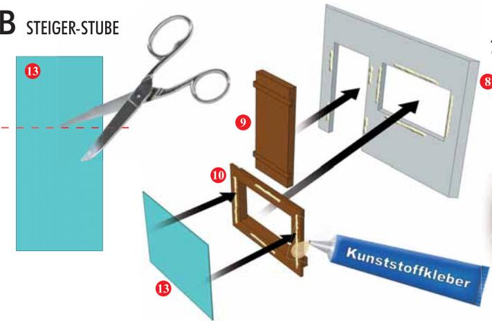
*Wenig Klebstoff verwenden. Bei filigranen Teilen den Klebstoff z.B. mit einer Stecknadel o.ä. auftragen.*
