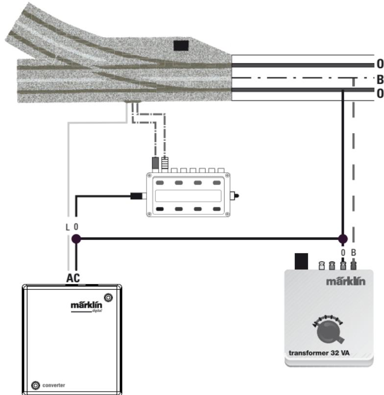
4. Anschluss M-Gleis Magnetartikel
