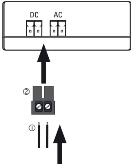
Zuerst die Kabel (1) in den Stecker (2) schrauben, danach den Stecker in die gewünschte Buchse stecken.
