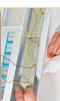
6. Dann wird die **Lichtschiene** hinter der Fensterreihe angeklebt.
