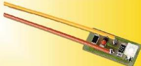
**Platine mit zwei LEDs für Hausbeleuchtung:**
