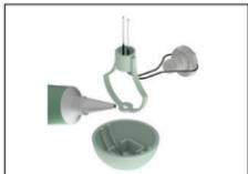
2. Der Lampenschirmhalter wird in den Lampenschirm eingeklebt.
