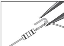
11. Anschließend biegen Sie das senkrecht hochstehende Ende des Widerstandes um.
