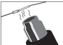
13. Kurz (!) erhitzen, etwa mit einer Heißluftpistole. Schon ist die dauerhafte Verbindung fertig! Vorsicht Verbrennungsgefahr!
