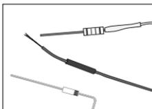
14. In gleicher Weise verfährt man mit dem braunen Kabel, dem schwarzen Schrumpfschlauch und der Diode (rotes Bauteil mit schwarzer Markierung).
