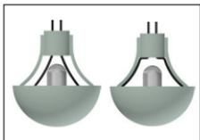
6. Kleben Sie die Kabel mit etwas Klebstoff an den Lampenschirmhalter.
