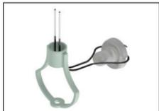
1. Die beiden Kabelenden werden durch den Lampenschirmhalter hindurchgefädelt.
