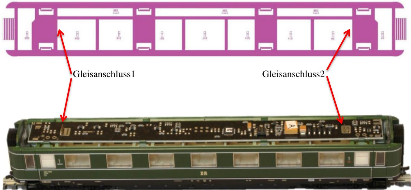
Löten Sie den Gleisanschluss an der Leiterplatte
