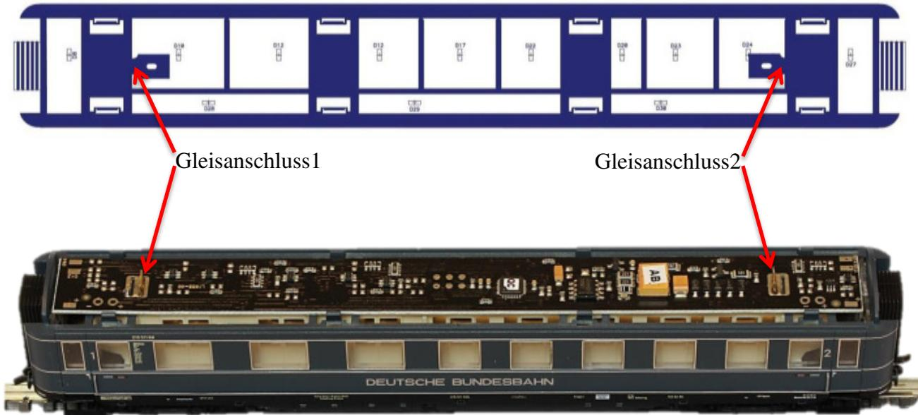
Löten Sie den Gleisanschluss an der Leiterplatte
