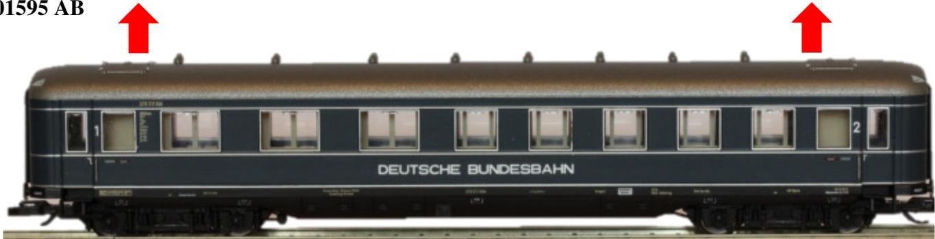
Ziehen Sie das Dach des Wagens, wie durch die Pfeile angedeutet, und entfernen Sie das Dach aus dem Körper.
