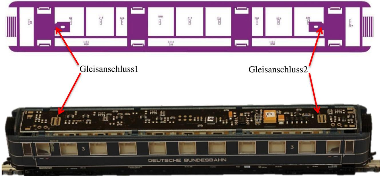
Löten Sie den Gleisanschluss an der Leiterplatte
