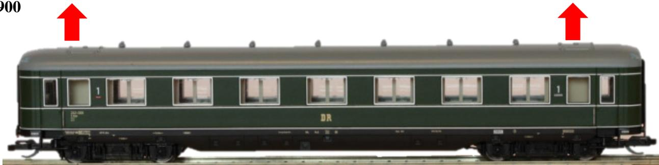
Ziehen Sie das Dach des Wagens, wie durch die Pfeile angedeutet, und entfernen Sie das Dach aus dem Körper.
