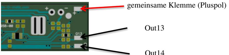
Die Ausgänge 13/14 sind für den Anschluss anderer Beleuchtungsmodule verfügbar, so Shine Micro für die Beleuchtung von Führerräumen oder Shine FDT als Zugschlussbeleuchtung.
