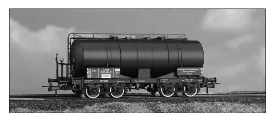
Ab 1922 entstanden Großkesselwagen der Bauart Krupp. Die ersten Exemplare dienten dem Transport von Teer. Fahrzeugtechnisch handelte es sich um zweiachsige Wagen mit vier Radsätzen – eine Bauform zwischen den herkömmlichen Zweiachsern und den heutigen Vierachsern mit Drehgestellen.
