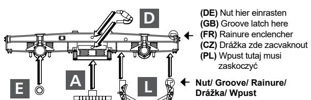
(DE) Drehgestell mit Achsgenerator und Dämpfer für Geschwindigkeiten > 140 km/h
