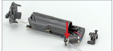
**Abbildung 17: Motorwelle schmieren**
