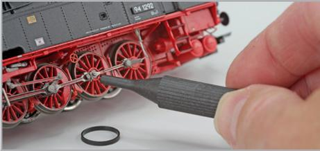
**Abbildung 20: Abschrauben des Kuppelzapfens**
