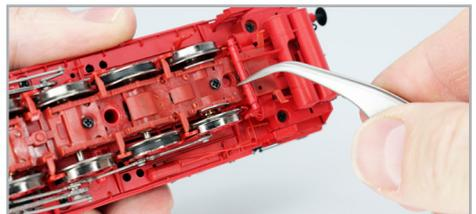
**Abbildung 19: Bremsgestänge abziehen**
