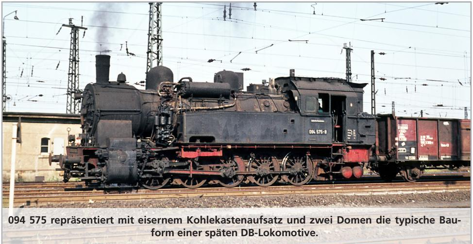
094 575 repräsentiert mit eisernem Kohlekastenaufsatz und zwei Domen die typische Bauform einer späten DB-Lokomotive.
