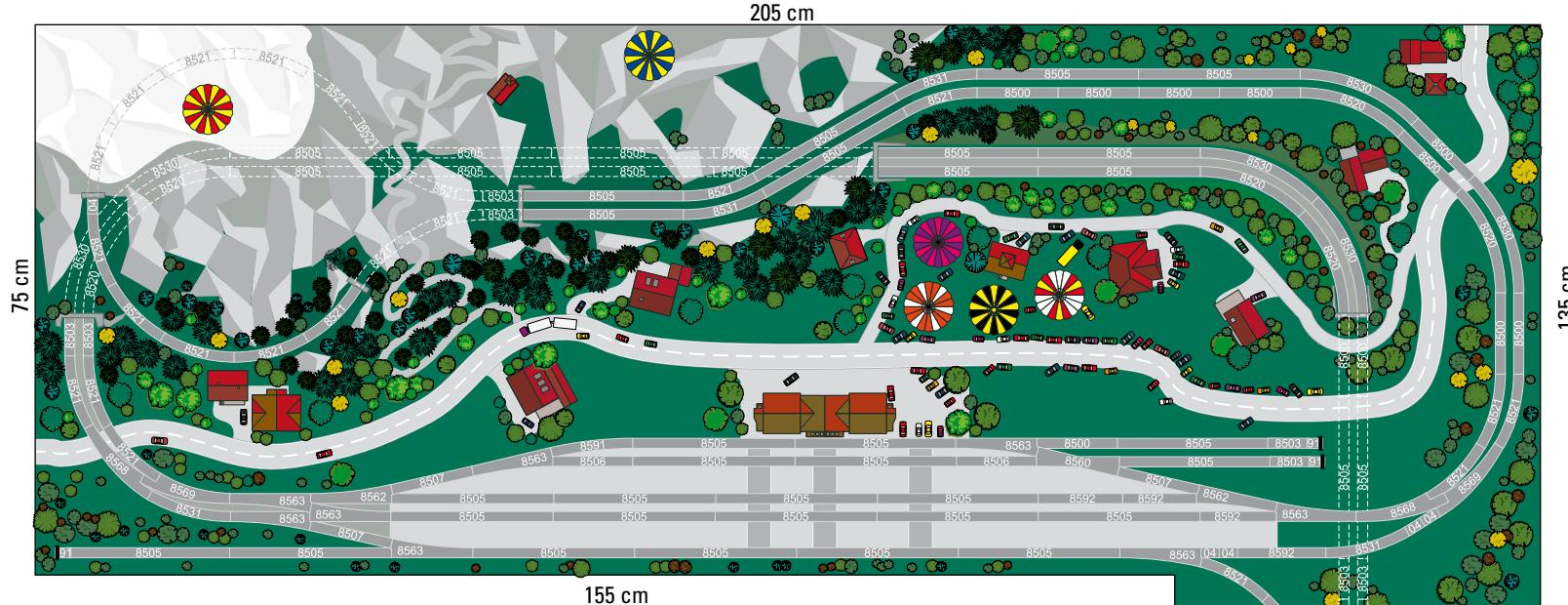
Hinweis: Diese Anlage besitzt zwei Kehrschleifen. Alternativ müssen Sie bei der Umsetzung entweder die Automatikschaltung mit dem zweipoligen Umschalter oder die Kehrschleifengarnitur 8993 verwenden.
