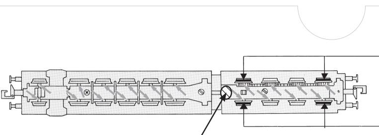
An der markierten Stelle kann der **Schaltmagnet 942701** eingebaut werden.
