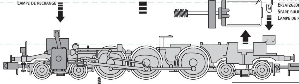
Reinigen der Lokräder: Bei Verschmutzung sind die Laufflächen der Räder mit sauberem Lappen oder Schienenreinigungsgummi 6595 zu reinigen. Niemals die angetriebenen Räder von Hand drehen, sondern durch Anlegen einer Fahrspannung mittels Anschlussdrähten antreiben. Nichtangetriebene Räder können von Hand gedreht werden.
