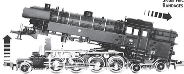
Ein Öffnen der Lok ist nur nötig zum Motorenwechsel und Ölen des Getriebes.
