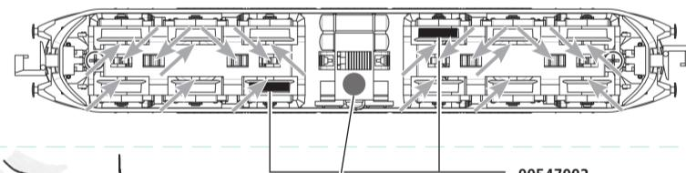
An den markierten Stellen kann der Schaltmagnet 942701 eingebaut werden.
