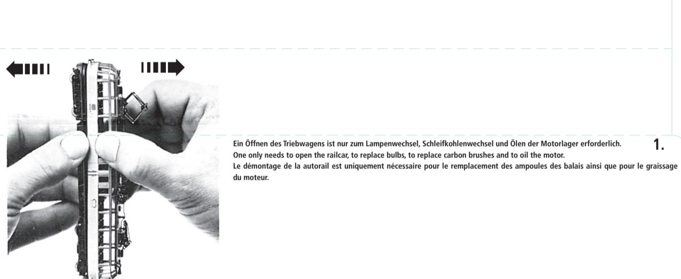
Ein Öffnen des Triebwagens ist nur zum Lampenwechsel, Schleifkohlenwechsel und Ölen der Motorlager erforderlich.
