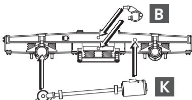
(DE) Drehgestell ohne Lichtmaschine mit Achslagerdeckel
