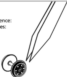
Si utilisation fréquente, huilez régulièrement avec une goutte d'huile fine pour machine à coudre. Nous vous conseillons un rodage complet de 25 min dans chaque sens pour un roulement optimal. Il est conseillé de nettoyer régulièrement vos rails pour un bon fonctionnement.
