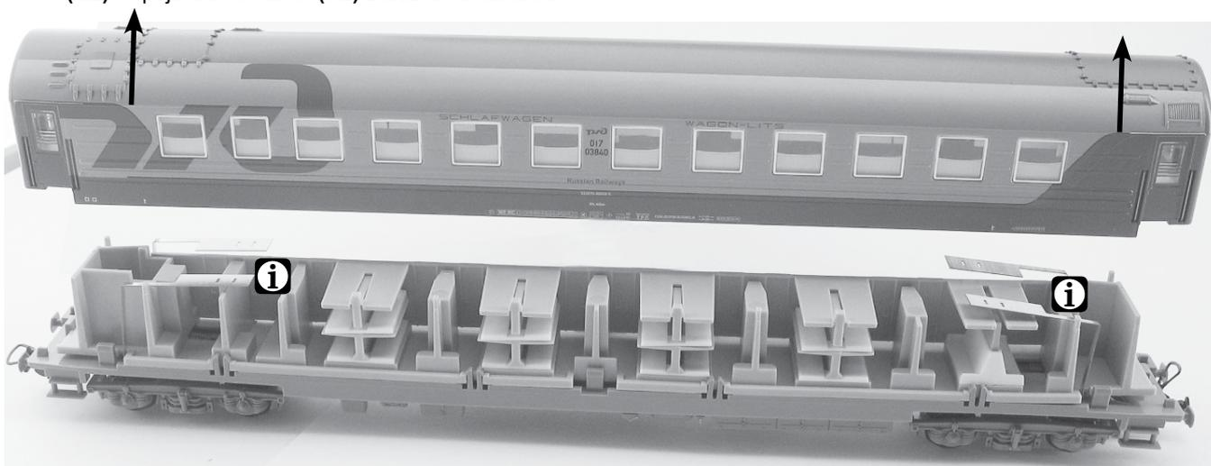
**(DE) Montage Radschleifer • (GB) Installation of wheel pick-up shoes • (FR) Montage des frotteurs d'essieux
