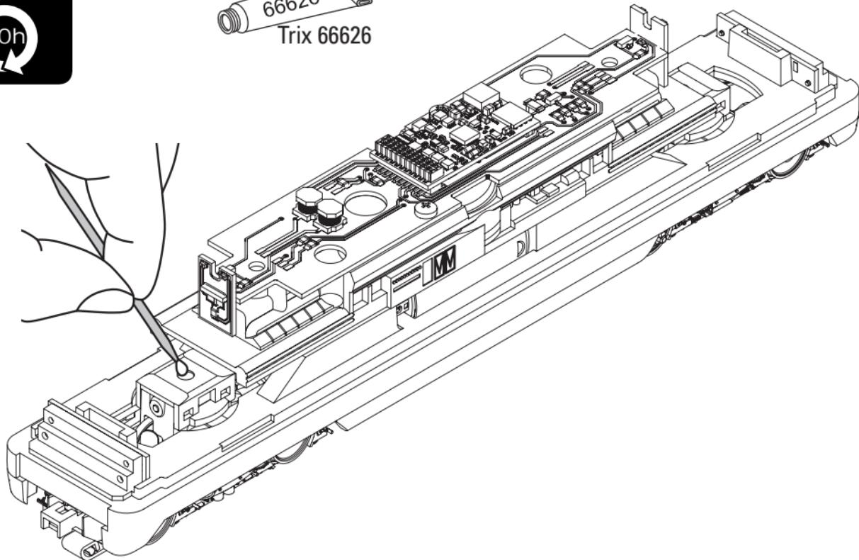
Der Artikel verfügt über einen Decoder mit mtc21-Schnittstelle. Die enthaltenen Decoderausgänge steuern verschiedene zusätzliche Funktionen an. Nur bei Verwendung des artikelspezifischen Märklin/Trixdecoders mit seiner speziell darauf abgestimmten SW-Konfiguration ist ein ordnungsgemäßer Betrieb dieser Zusatzfunktionen gewährleistet. **Die Verwendung anderer Komponenten kann zu Beschädigungen führen!**
