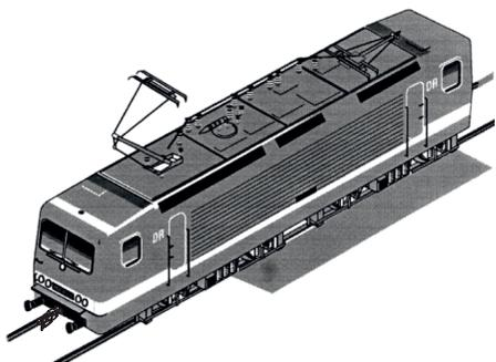
(DE) Zur weiteren Detaillierung des Modells liegen einige Teile zur Selbstmontage bei. Die Griffstangen, Bremsschläuche und Kuppelhaken werden in die Öffnungen des Oberteils (siehe Ersatzteilliste) für die dafür vorgesehenen Bohrungen mittels einer kleinen Zange eingesteckt. Die Zurüstteile sollten mit einem Tropfen Sekundenkleber fixiert werden. Beim Betriebseinsatz ist zu beachten, dass die Bremsschläuche die Funktion der Kuppelungsdeichsel behindern.
