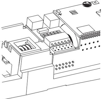
**(DE)** Für eine Digitalisierung gibt es im Modell eine PluX12-Schnittstelle. Wir empfehlen die Verwendung eines Decoders PluX12 von Uhlenbrock (TILLIG Art.-Nr. 66035). Zum Einbau des Decoders ist das Oberteil entsprechend der Anleitung auf Seite 1 abzunehmen. Quer in der Rahmenaussparung befindet sich die Decoderschnittstelle.
