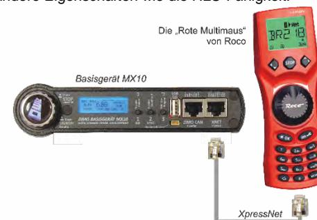
Die kabelgebundene (rote) multiMAUS wird mit dem zugehörigen Kabel an der XNET-Buchse des MX10 (Vorderseite) angeschlossen. Im Menü „Bus Config+Monitor“ ist unter „XNET1“ auf „for Lokmouse“ umzustellen. Bezüglich Funk-Kontakt mit der (schwarzen) WLANMAUS: siehe vorhergehendes Kapitel.
