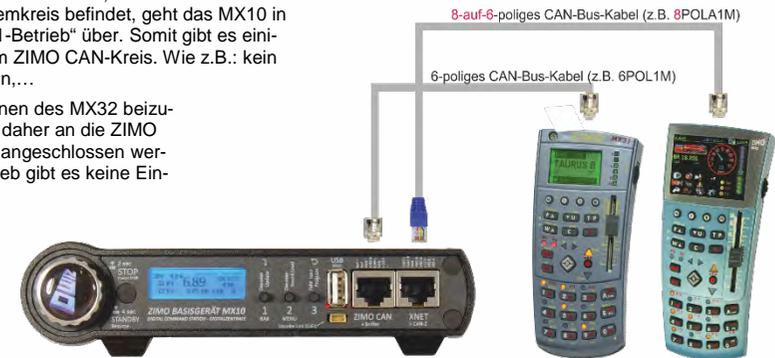
Diese Verkabelungsweise ist auch einzuhalten, wenn **MX8 und/oder MX9** zur Anwendung kommen. Diese Module werden wie ein MX31 an den „normalen“ ZIMO CAN angeschlossen und die MX32 an „CAN2“ auf der XNET-Buchse, wie oben beschrieben.
