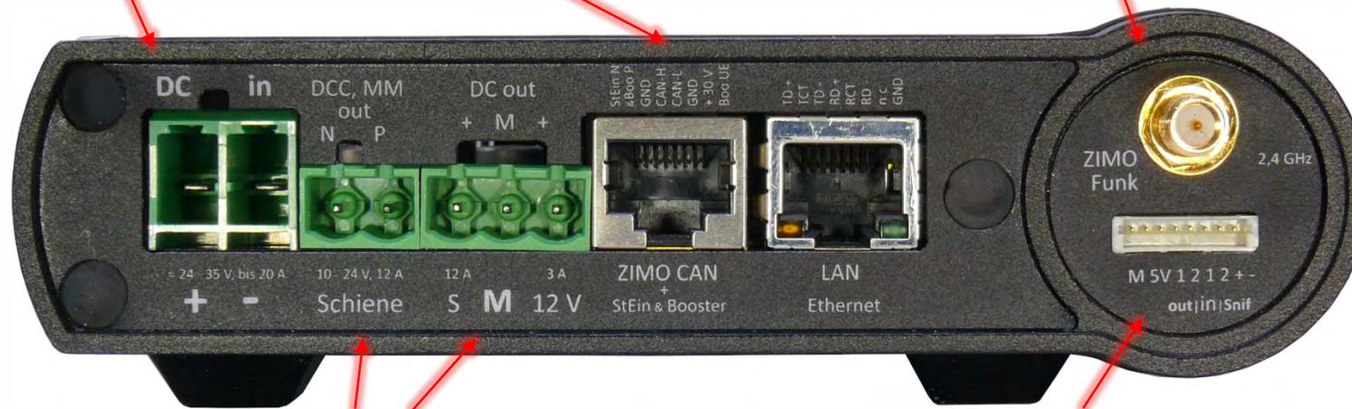
**Ausgänge: Schiene | Schienengleichspannung (DC out)**
