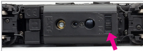
Abbildung 6: DC-AC-Umschalter auf Position „DC“
