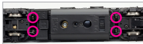
Abbildung 9: Sitz der Gehäuseschrauben
