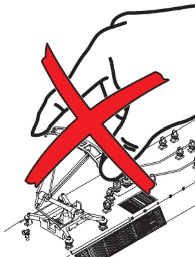
**Avvertenza:** Prima del primo esercizio della locomotiva i pantografi devono venire sbloccati a mano. Il pantografo si molleggia automaticamente in alto nella posizione superiore.
