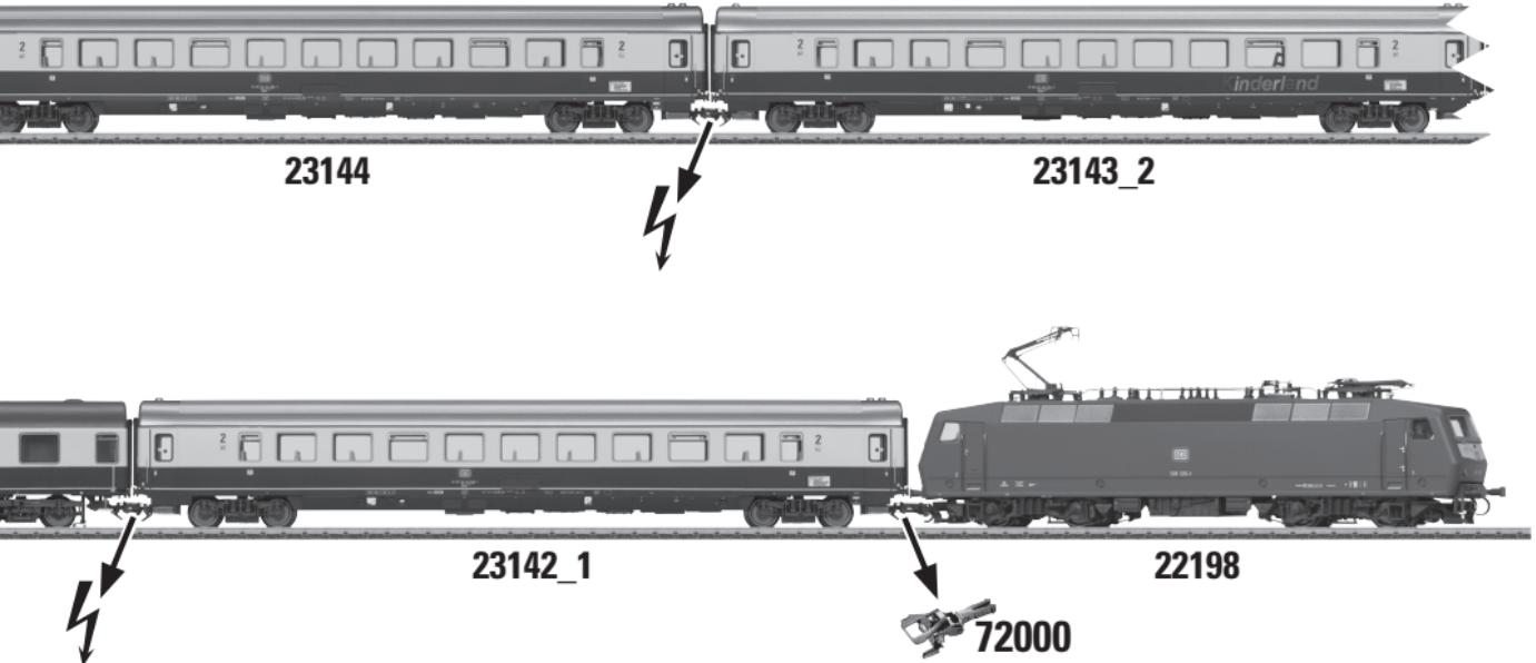
**⚡** = stromführende Kupplung; current-conducting couplers; Accouplements conducteurs; Spanninggeleidende koppelingen;
