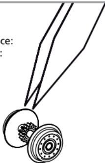
Si utilisation fréquente, huilez régulièrement avec une goutte d'huile fine pour machine à coudre. Nous vous conseillons un rodage complet de 25 min dans chaque sens pour un roulement optimal. Il est conseillé de nettoyer régulièrement vos rails pour un bon fonctionnement.
