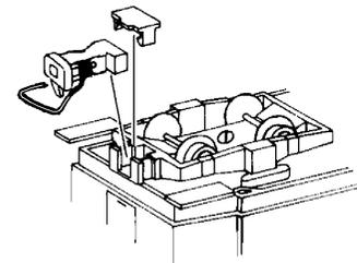
**2. Aushängen des Drahtbügels und Abschneiden des T-Stückes**
