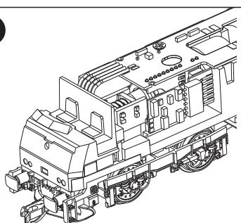
**(DE)** Für eine Digitalisierung gibt es im Modell eine PluX12 Schnittstelle. Wir empfehlen die Verwendung eines Decoders PluX12 von Uhlenbrock (TILLIG Art.-Nr. 66034).
