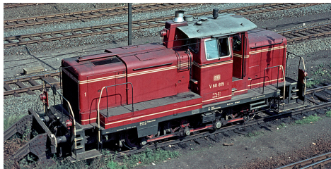
Dachansicht der V60 815 mit Topfantenne.
