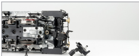
Abbildung 8: Kupplung Höhenverstellung - Abdeckung abschrauben
