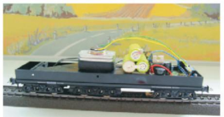
Die Reinigungstechnik wird von einem langlebigen und wartungsfreien Glockenankermotor (Faulhaber<sup>1</sup>) angetrieben.
