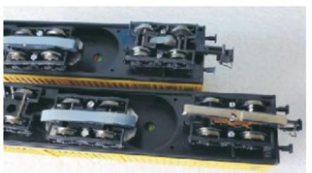
gegen Verschmutzung geschützt. Der Antriebsblock wird durch eine Stützplatte im Wagenchassis gehalten.
