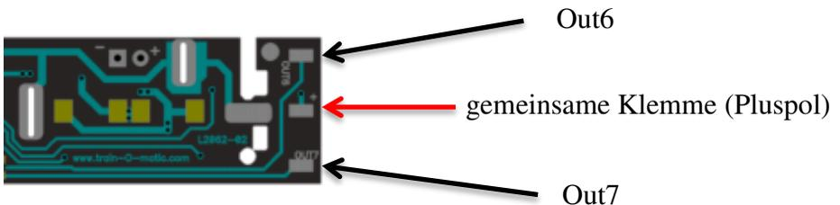
Die Ausgänge 6/7 sind für den Anschluss anderer Beleuchtungsmodule verfügbar, so Shine Micro für die Beleuchtung von Führerräumen oder Shine FDT als Zugschlussbeleuchtung.
