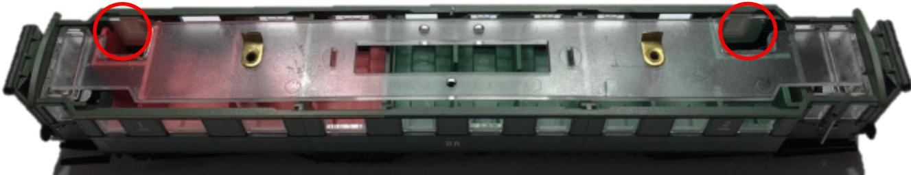
Am einfachsten ist der Freiraum mit einem Bohrer im Durchmesser 8 mm herstellbar.
