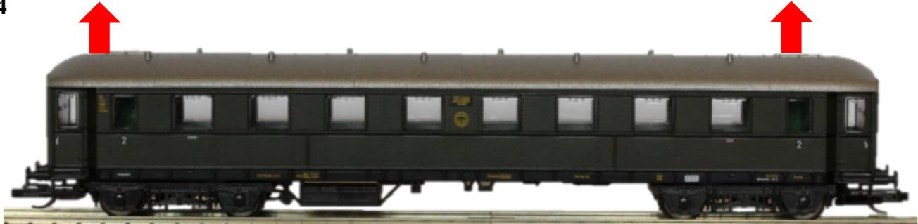
Ziehen Sie den Dach des Wagens, wie durch die Pfeile angedeutet nach oben,
