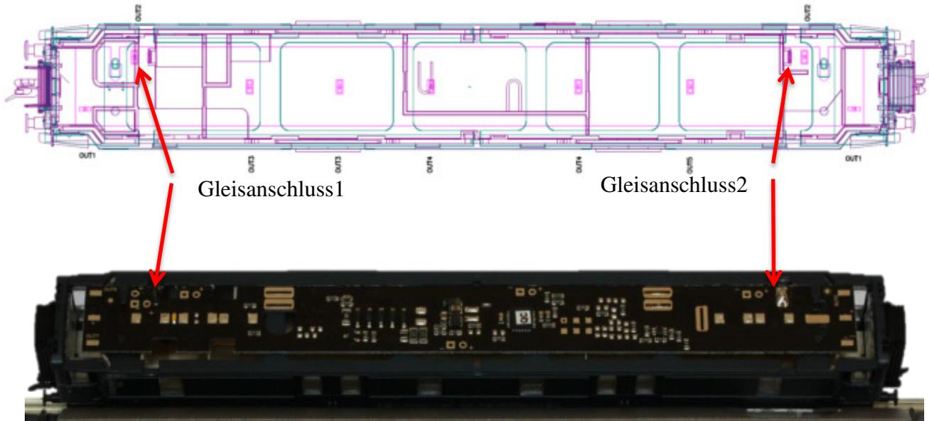
Löten Sie den Gleisanschluss an die Leiterplatte
