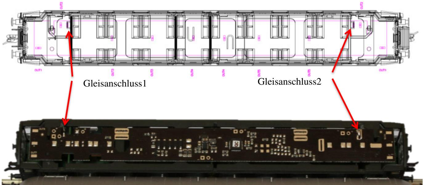
Löten Sie den Gleisanschluss an die Leiterplatte
