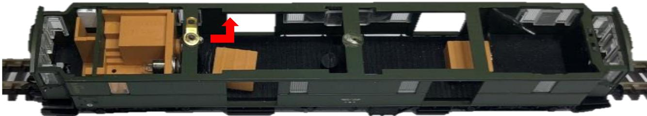
Setzen Sie den Beleuchtungsmodule in der richtigen Position, wie angegeben, auf das Oberteil.
