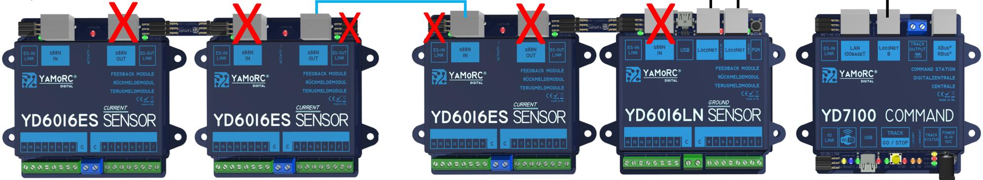
**Maximalausbau:** 96 Rückmelder, bestehend aus fünf Rückmeldemodule mit je 16 Eingängen im gesamten "ES-Link" Strang.
