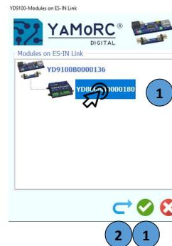
Das Modul, das Sie konfigurieren möchten, durch Anklicken auswählen und die Konfigurationssoftware durch Doppelklick oder mit dem grünen Haken starten. ①
