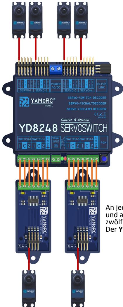
An jedem **YD8291** können vier RC-Servos angesteckt und angesteuert werden. So können mit zwei **YD8291** zwölf RC-Servos an einem **YD8248** betrieben werden. Der **YD8291** ist optional erhältlich.
