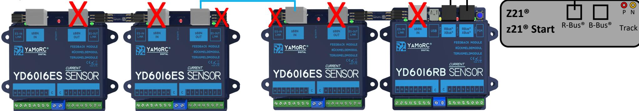
**Maximalausbau an einem YD6016RB-xx:** 80 Rückmelder, bestehend aus **einem** Rückmeldemodul YD6016RB-xx und **vier** Rückmeldemodulen YD6016ES-xx mit je 16 Eingängen im gesamten "ES-Link" Strang. Am gesamten R-Bus<sup>®</sup> sind technisch bedingt maximal 160 Rückmelder möglich.
