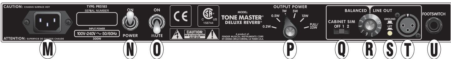
**M. GNIAZDO ZASILANIA:** Podłącz dołączony przewód zasilania do uziemionego gniazdku elektrycznego zgodnie z wartościami napięcia i częstotliwości podanymi na etykiecie umieszczonej z boku gniazda. Zakres pracy to 100V–240V.
