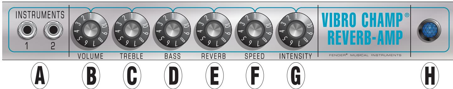
**A. EINGÄNGE:** Schließen Sie hier Ihre Instrumente an. Eingang 1 erzeugt volle Empfindlichkeit; Eingang 2 hat eine geringere Empfindlichkeit (-6 dB) für ein saubereres Ergebnis bei Instrumenten mit stärkerem Ausgangssignal und bei vorverstärkten Instrumenten.
