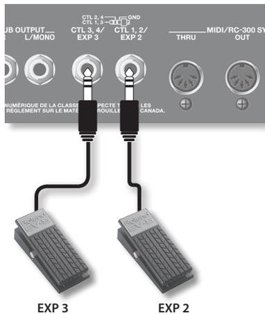
\* Verwenden Sie nur das von Roland empfohlene Expression-Pedal (EV-5). Bei Verwendung eines Pedals eines anderen Herstellers können Fehlfunktionen auftreten.
