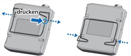
\* Achten Sie darauf, bei Lösen bzw. Befestigen des Klemmverschlusses nicht die Oberfläche des Geräts zu zerkratzen.
